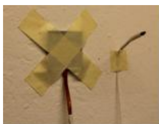
Εικόνα 16 - Αισθητήρας ροής θερμότητας και εσωτερικός αισθητήρας θερμοκρασίας
